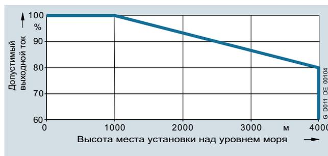
Доп. выходной ток в зависимости от высоты места установки
