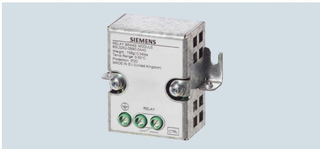
Реле тормоза позволяет установить соединение между силовым модулем и электромеханическим тормозом двигателя. Тем самым возможно управление тормозом двигателя непосредственно с управляющего модуля.
