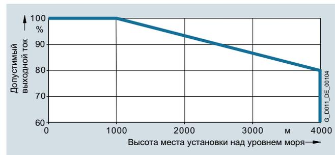
Допустимый выходной ток в зависимости от высоты места установки для силовых модулей PM250 типоразмеры FSC до FSF
