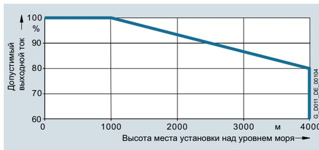
Доп. выходной ток в зависимости от высоты места установки для силовых модулей PM230 типоразмеры FSA до FSF
