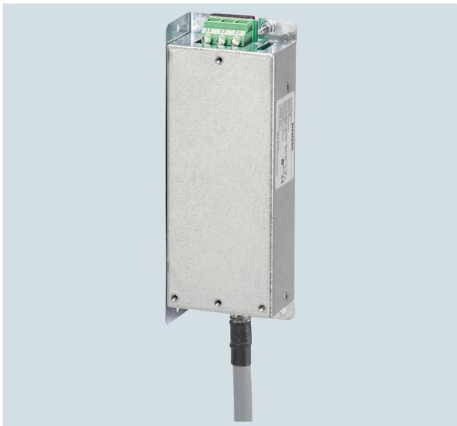
Сетевой фильтр для типоразмера FSA как часть отвечающей действующим требованиям установки ограничивает кондуктивные помехи от силового модуля PM340 до предельных значений категории C2 по EN 61800-3. Сетевой фильтр подходит только для прямого подключения к сетям TN.
