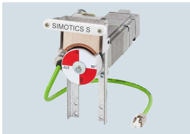
Сервомодуль служит для добавления **сервофункции** к учебному комплекту модульного одноосевого привода. Сервомодуль состоит из серводвигателя SIMOTICS S-1FK7 с **механизмом нагрузки** и пристраиваемой **механической части**. Кабель датчика является частью сервомодуля. Силовой кабель входит в объем поставки модульного учебного комплекта SINAMICS.
