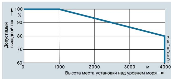
Допустимый выходной ток в зависимости от высоты места установки для силовых модулей PM240 типоразмеры FSD до FSF
