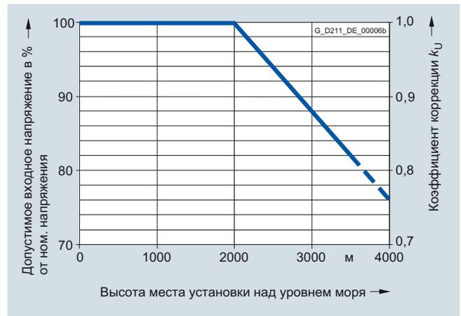
Снижение номинальных значений напряжения в зависимости от высоты места установки
