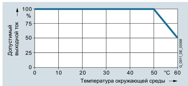
Высокая перегрузка (high overload HO) для силовых модулей PM230 типоразмеры FSA до FSF
