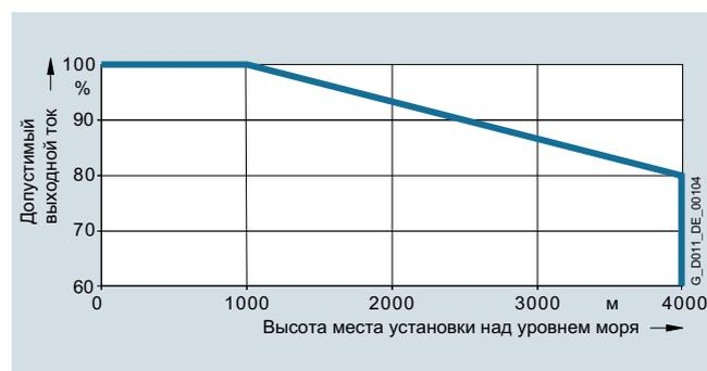
Допустимый выходной ток в зависимости от высоты места установки для силовых модулей PM240M, типоразмеры FSA и FSB
