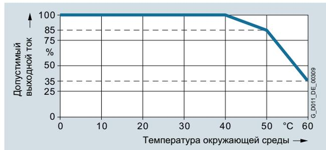
Низкая перегрузка (low overload LO) для силовых модулей PM230 типоразмеры FSA до FSF
