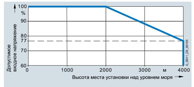
Допустимое входное напряжение в зависимости от высоты места установки для силовых модулей PM250D типоразмеров FSA до FSC
