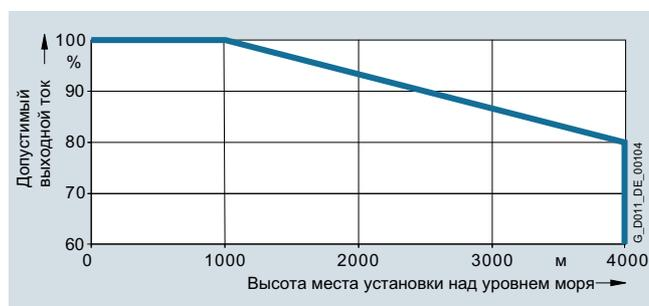
Допустимый выходной ток в зависимости от высоты места установки для силовых модулей PM240-2
