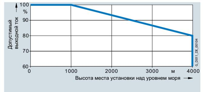
Допустимый выходной ток в зависимости от высоты места установки для силовых модулей PM250D типоразмеров FSA до FSC
