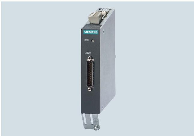
Для обработки сигналов датчика от двигателей без интерфейса DRIVE-CLiQ необходим монтируемый в шкаф модуль датчика SMC10. Через SMC10 могут быть подключены и внешние датчики.
