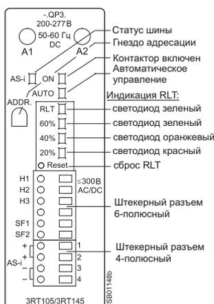
Для питания электромагнитных приводов и устройства сигнализации остаточного ресурса контактов напряжение  $U_s$  должно быть подведено к зажимам A1/A2 бокового электронного модуля. Входы и выходы выведены на 10-полюсный штекерный разъем. Штекеры (6-полюсный для внешнего подключения и 4-полюсный для AS-интерфейса) с безвинтовым пружинным соединением входят в комплект поставки.
