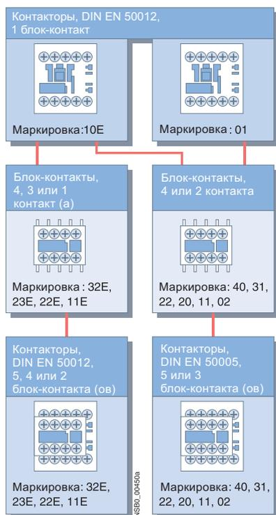
Все контакторы типоразмера S00 имеют один встроенный блок-контакт.
