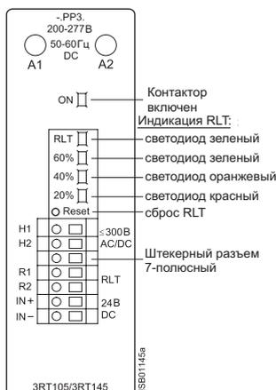
Для питания электромагнитных приводов и устройств сигнализации остаточного ресурса контактов напряжение  $U_s$  подается на клеммы A1/A2 бокового электронного модуля. Управляющие входы контактора выводятся на 7-полюсный штекерный разъем. Штекер с безвинтовым пружинным соединением входит в комплект поставки.
