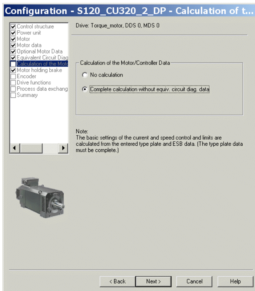
Изображение 3-76 Окно расчета данных двигателя/регулятора
