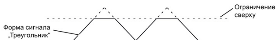
Изображение 4-2 Форма сигнала «Треугольник» без вершины
